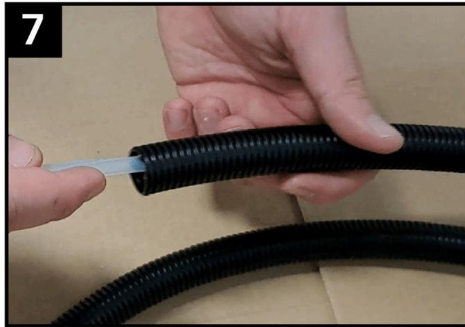
**Paso 7.** Para preparar las mangueras de detección de presión, introduzca las dos mangueras a través del conducto.
