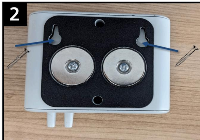
**Segundo paso.** Como alternativa, fije dos tornillos a 60 mm entre centros a una superficie vertical plana y enganche el monitor a los tornillos. Diámetro máximo de la rosca: 3,5 mm; diámetro máximo de la cabeza: 8,5 mm.
