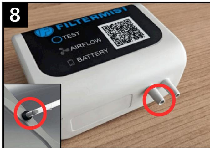
**Paso 8.** Conecte la manguera marcada con bolígrafo a la boquilla del diafragma. A continuación, conecte a la boquilla izquierda en la parte inferior del monitor.
