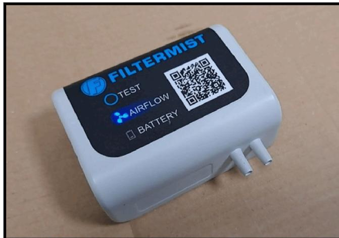
Si parpadea una luz azul, significa que el monitor no está calibrado. Si ha intentado calibrarlo, entonces no ha reconocido el flujo de aire. Deberá volver a calibrarlo.
