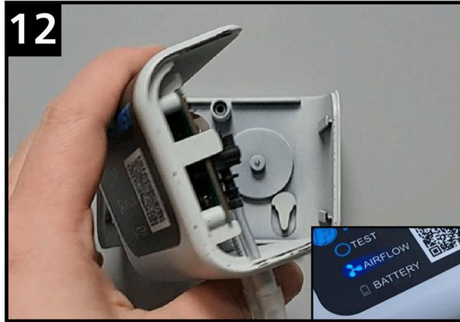
**Paso 12.** Retire los dos tornillos de la parte posterior del Monitor F Essential. A continuación, retire la tapa posterior, inserte las pilas y se producirá un doble destello blanco en las luces de flujo de aire y de las pilas. A continuación, parpadeará una luz azul en la luz de flujo de aire frontal. Compruebe que las mangueras están conectadas dentro del monitor.
